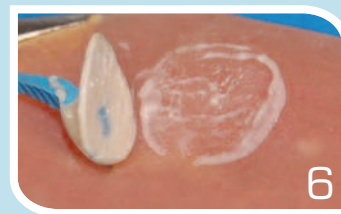
6 Une fois le matériau durci, tirer sur la tige. Si le matériau se décolle sans effort, cela signifiera qu'il n'y a pas de compatibilité entre l'adhésif et le matériau
