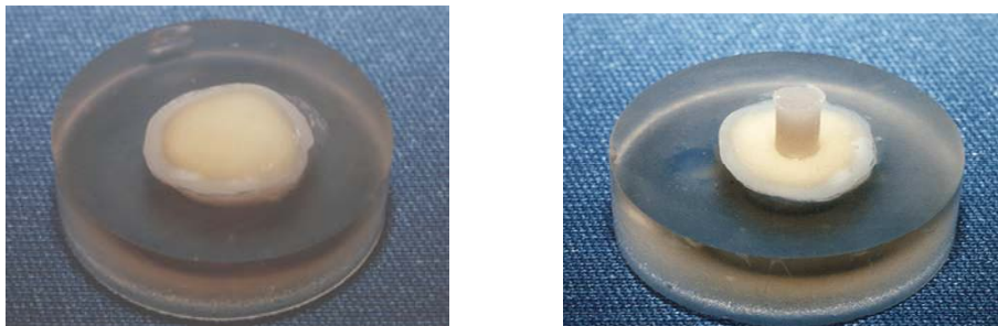
Figure 1 : Échantillon de dentine coronaire enrobé et poli avant collage (à gauche). É échantillon après application de l'adhésif et du composite avant essai (à droite)
